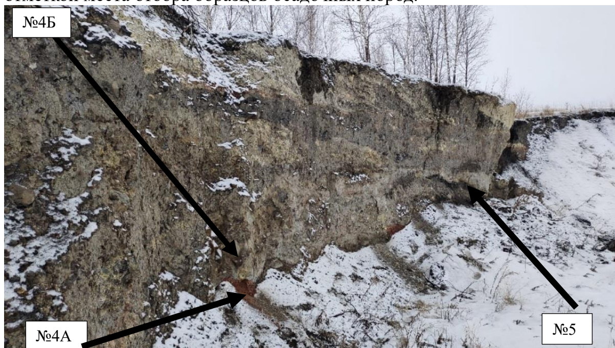
Фото. 8. Обнажение № 2 на отвалах угольного карьера «Октябрьский» с отметкой места отбора образцов осадочных пород
