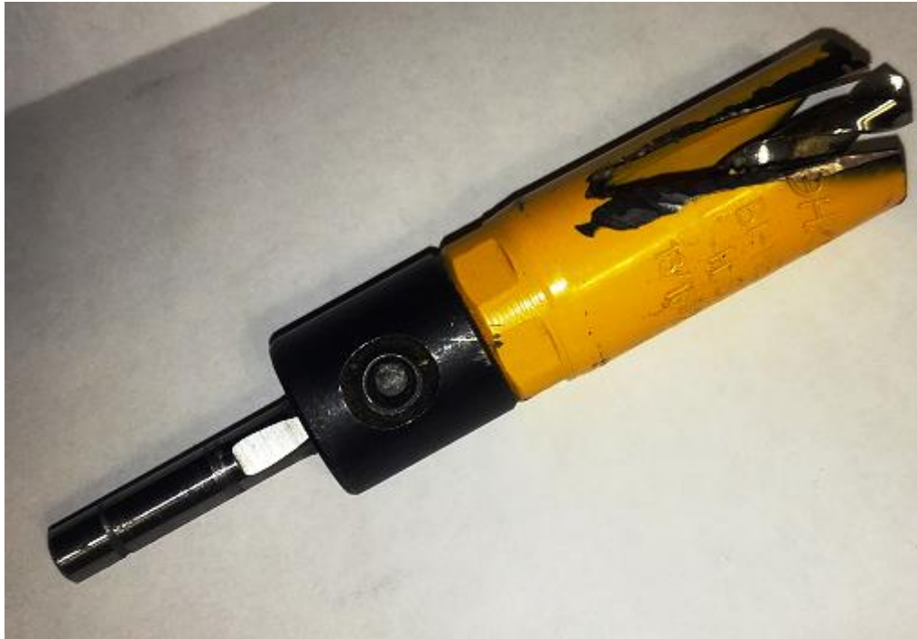
фото 9. Использованный прибор для извлечения кернов конструкции В.Жукова
